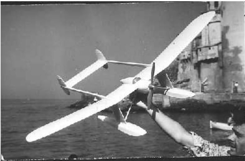
Il mio progetto GAM-4, di 1.3m di apertura, e motorizzato con il MOVO-D2, volò in volo libero molte volte nei golfi Tigullio e Paradiso.
